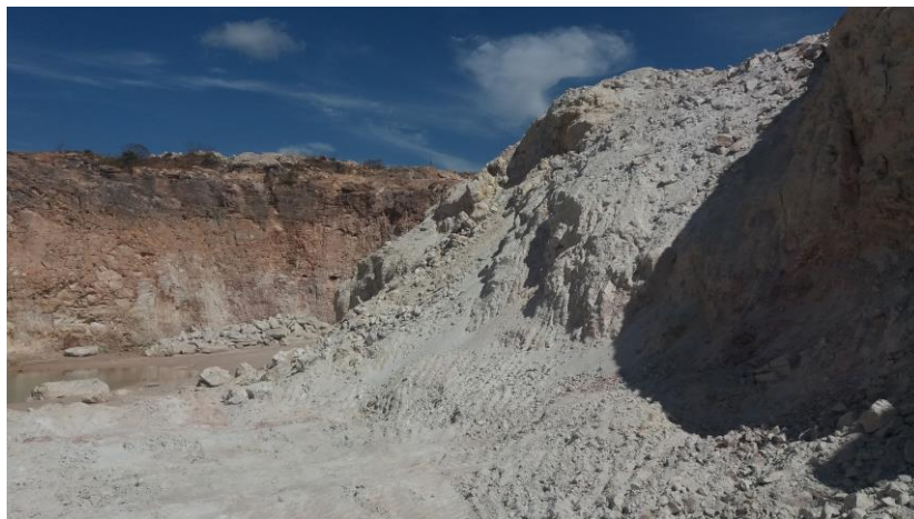
FIGURA 10 – Mina de extração de quartzo. À direita do leitor, areia branca e “casas de abelha”. À esquerda, quartzo exposto com os veios de cristais. Fazenda Chapéu do Sol, Cristalina (GO). Foto: autoria própria.
