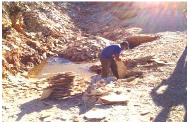
FIGURA 8 – Trabalhador em extração de sílica sem equipamento próprio, exposto a partículas. Foto: SRTE/MG 41 .
