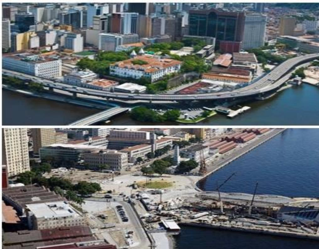
Fotografia 3: Na primeira foto o Viaduto Elevado da Perimetral ainda existia. Na segunda foto o Viaduto já foi demolido. Na primeira foto, na parte superior à direita os edifícios pequenos ao fundo correspondem ao Museu de Arte do Rio – MAR. Os mesmos aparecem na segunda foto na parte superior à esquerda. Ainda nesta foto temos obras do Museu do Amanhã, no Píer Mauá e a Praça Mauá ao centro.
